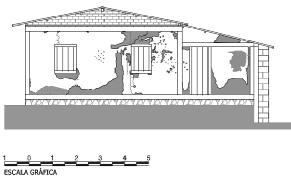
Figura 9 – Fachada Sudeste (Frontal) – Representação e Foto / Fazenda Curralinho / Brazlândia – DF. Elaborada após levantamento métrico e anotação de patologias a partir das fotos da Ficha de Identificação de Danos - FID. Autores: DOWSLEY, Isabela. NOLETO, Natalia. REZENDE, Rogério. Orientação para identificação de Patologias: Oscar Luís Ferreira. Levantamento de Patologias da Sede da Fazenda Curralinho – Brazlândia – DF. Trabalho de curso da disciplina ‘Projeto de Arquitetura e Urbanismo – PROAU 08’.
